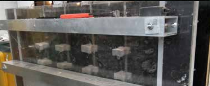
Afstandsklodser monteret i 1 x 1 x 0,2 m form
