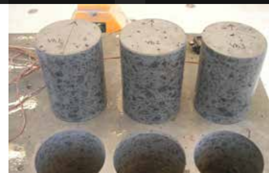
De udborede kerner til frostprøvning
