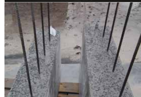
Til fremstilling af kolde støbeskel blev 5-10 mm af tilslaget fritlagt ved sandblæsning
