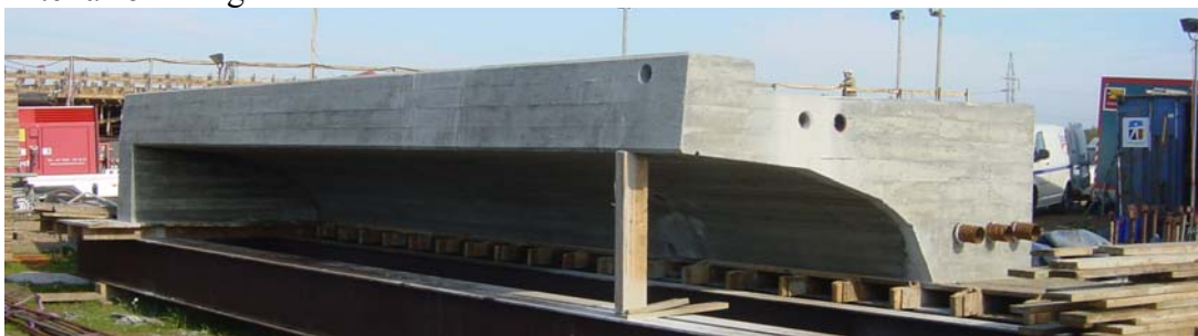
Figur 2-5: Brodæksprøvestøbning 28-09-2006 på brostedet ved Give.
