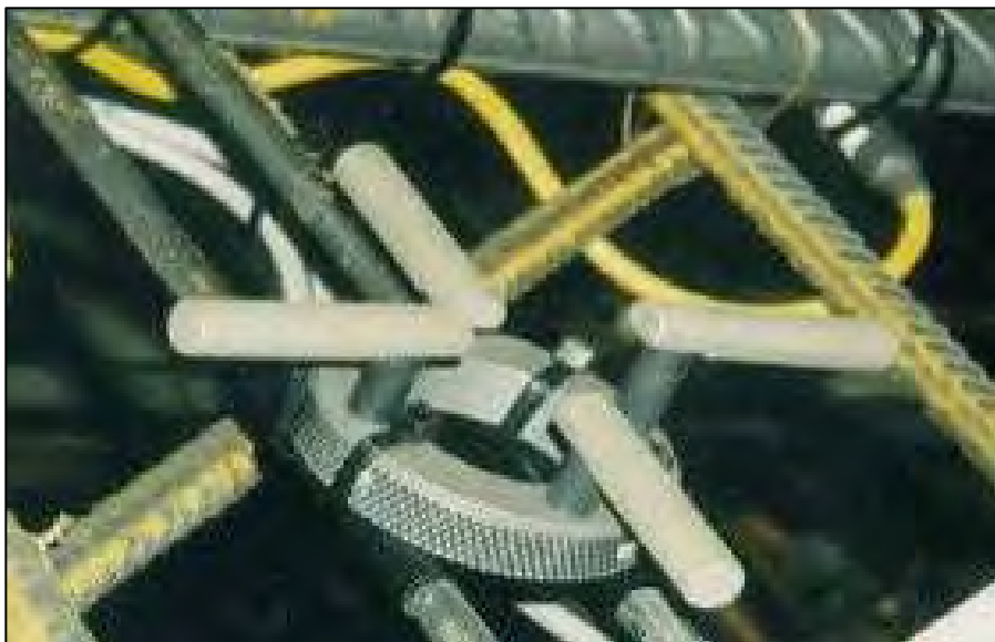
Eksempel på kablede sensorer placeret i forskellig afstand fra betonoverfladen (CorroEye fra Force)
