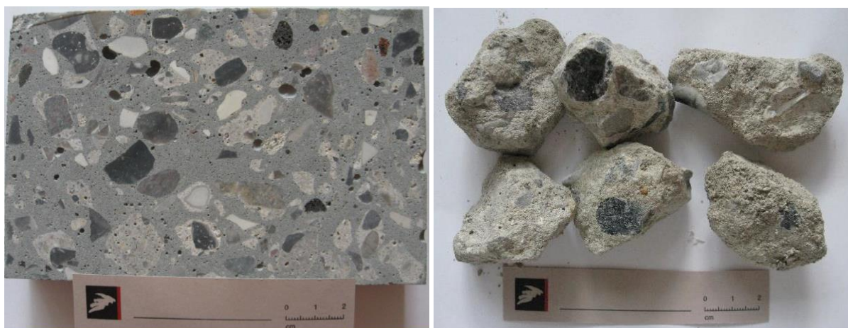
Figur 11. Gennemskåret prøve af beton med 100 % erstatning (til venstre) og udvalgte større korn af nedknust beton fra banebro (til højre).
