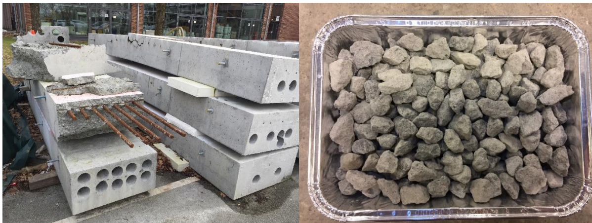
Figur 1. Bjælker (til venstre) og 8/16 mm fraktion af den nedknuste beton fra bjælker (til højre).
