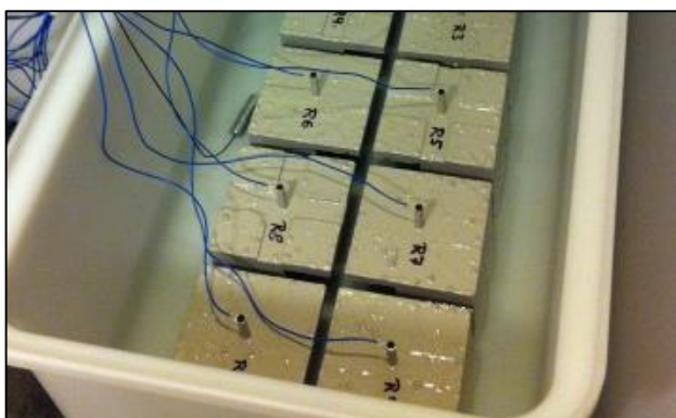
Betonprøver med indstøbte armeringsjern i forsøg med bestemmelse af chloridtærskelværdier.
