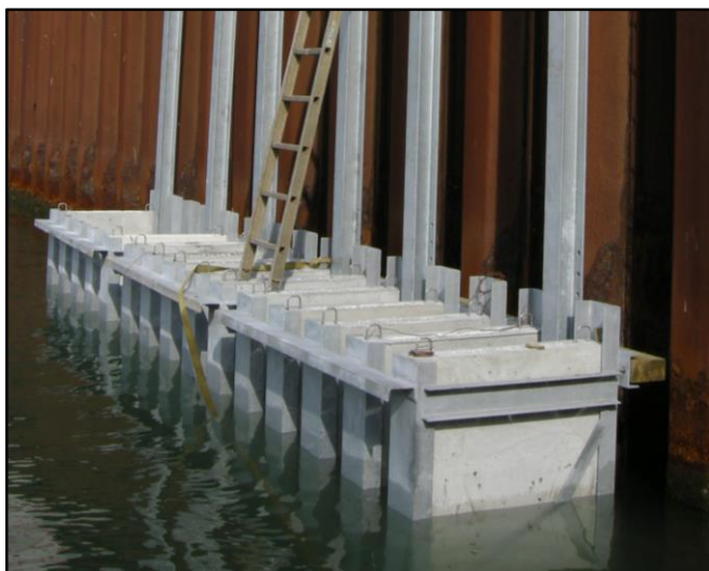
Betonblokke delvist neddykket i havvand ved Femern A/S' marine eksponeringsplads i Rødbyhavn.
