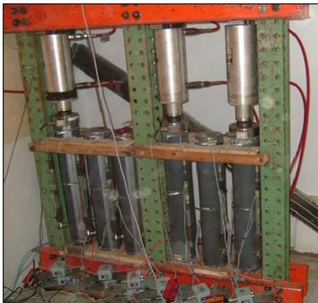
Forsøgsopstilling til måling af tøjninger hidrørende fra svind i betonprøver.
